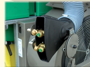
Diffusore con getti dentro flusso aria per minore effetto deriva del prodotto. Sprayers with inside air flow for reduced arises effect of the chemicals.
